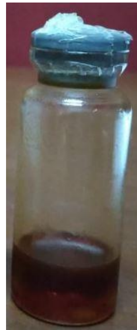
Minyak esensial percobaan pertama yang gagal karena suhu terlalu tinggi
